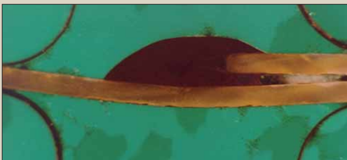
Obr. 1. Preplátovaný spoj MIG – spájkovanie [5]
