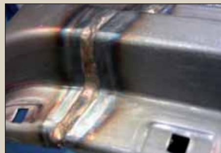
Obr. 3. Spoj spájkovaný TOPTIG [7]
