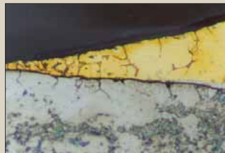
Obr. 2. Makrovýbrus z preplátovaného spoja [5]
